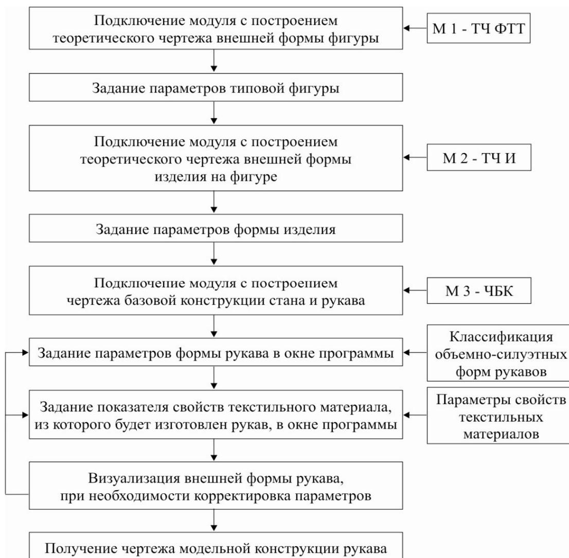
Рис. 1. Структура алгоритма построения внешней формы рукава
