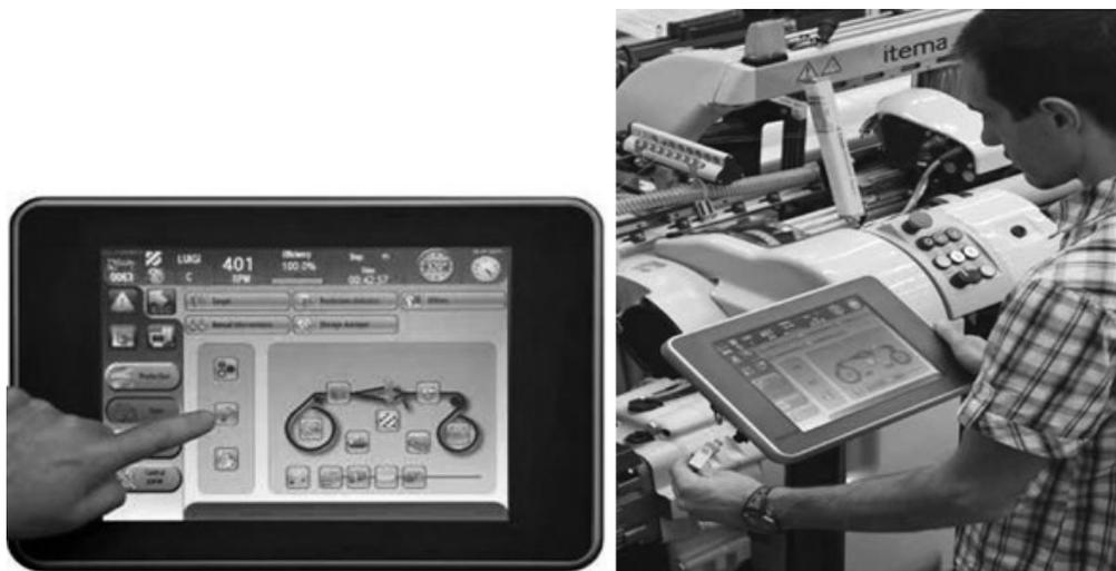
**Рис. 1. Управление станком сенсорным дисплеем и перенос настроек станка при помощи Memory Stick USB**
